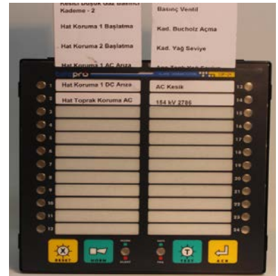
Şekil3-Etiketleri şekildeki gibi takınız
