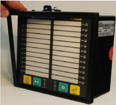
Şekil1-Ön çerçeveyi bir kenarından tutarak ayırınız
