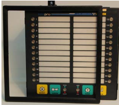
Şekil2-Ön çerçeveyi tamamen çıkartınız
