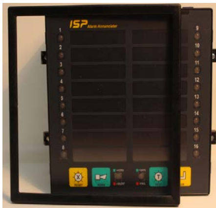
Şekil2-Ön çerçeveyi tamamen çıkartınız
