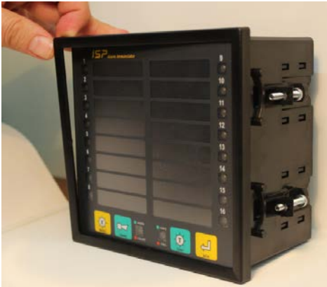
Şekil1-Ön çerçeveyi bir kenarından tutarak ayırınız
